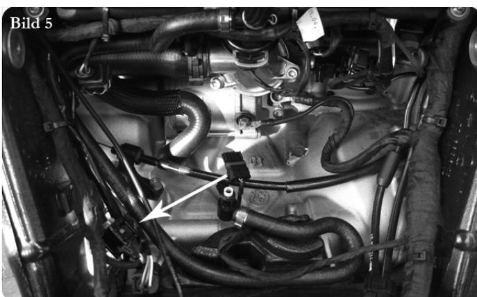
7. Auf der linken Seite des Motorrads (Siehe Pfeil auf dem Bild 5) finden Sie den Stecker mit dem Gas-Position Kabel.
