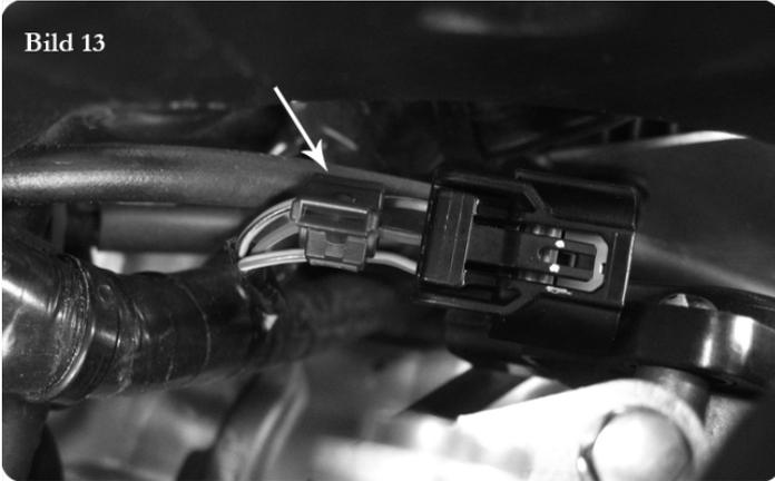
14. Ziehen Sie den Stecker ab und befestigen Sie an das **mittlere** Kabel den mitgelieferten roten Kabelabzweiger. Stellen Sie sicher, dass der Kabelabzweiger komplett zusammengedrückt wurde. Sie können eine Zange benutzen, um diesen zusammenzudrücken.
