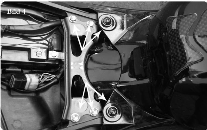
4. Entfernen Sie alle Schrauben, die auf dem Bild 4 markiert sind.
