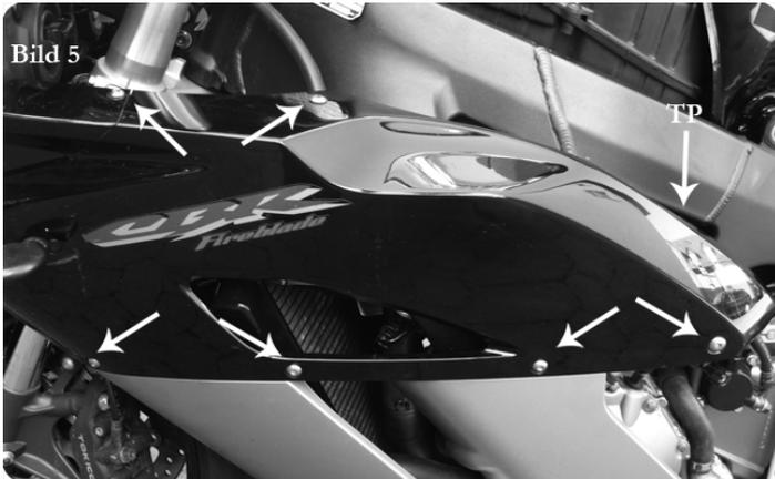
6. Entfernen Sie alle Schrauben der linken Seitenverkleidung, die auf dem Bild 5 markiert sind.
