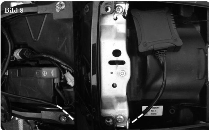
9. Heben Sie die Heckverkleidung ein bisschen hoch. Verlegen Sie den Kabelbaum des Pk-Power Dragon Gerätes so, dass dieser unter der Heckverkleidung auf der Batterieseite verläuft. Das Pk-Power Dragon Gerät soll im Sozusbereich liegen
