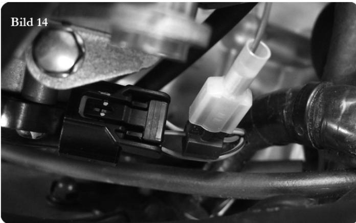
15. Befestigen Sie den Stecker auf dem grauen Kabel des Pk-Power Dragon Kabelbaums bis auf Anschlag an den Kabelabzweiger. Schließen Sie danach den Drosselklappenstecker wieder an seine ursprüngliche Position an.
