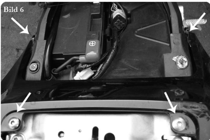
7. Entfernen Sie die Schrauben von der Heckverkleidung, die auf dem Bild 6 markiert sind
