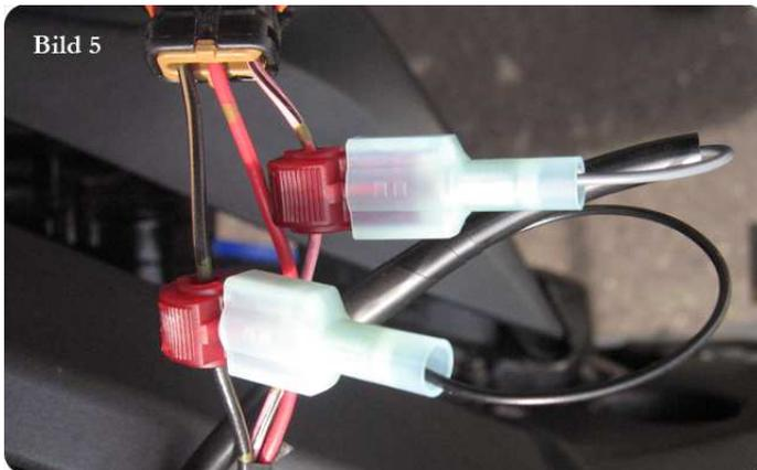
8. Befestigen Sie den Stecker auf dem **grauen** Kabel des Pk-Power Dragon Kabelbaums bis auf Anschlag an den Kabelabzweiger auf dem **pink/schwarzen** Kabel (Bild 5).
