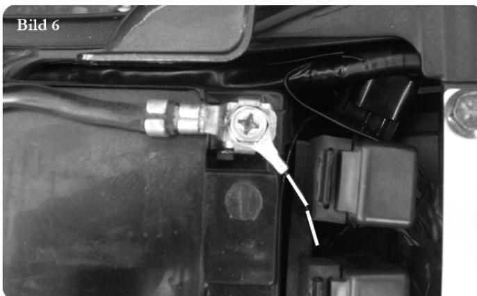
10. Verbinden Sie das schwarze Kabel des Pk-Power Dragon Kabelbaums mit dem Minuspol der Batterie (siehe Bild 6)
