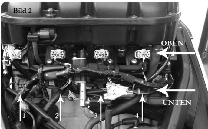
4. Ziehen Sie die Stecker der auf dem Bild 2 markierten Einspritzdüsen ab. Achten Sie dabei drauf, dass Sie die **UNTEREN** und nicht die oberen Einspritzdüsen lokalisiert haben
