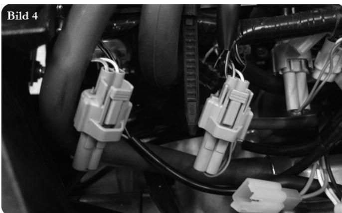
6. Verbinden Sie die Stecker vom Pk-Power Dragon Kabelbaum mit Einspritzdüsen und mit den Fahrzeugsteckern wie auf dem Bild 4. Achten Sie darauf, dass Sie den Pk-Power Dragon Stecker mit dem **gelben** Kabel mit der **rechten** Einspritzdüse verbinden (Auf dem Bild 3 mit 4 markiert)
