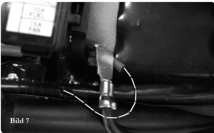
8. Ziehen Sie den Drosselklappenstecker ab und befestigen Sie den mit Pk-Power mitgelieferten Abzweiger auf das **pink/schwarze** Kabel. Befestigen Sie den Stecker auf dem **grauen** Kabel des Pk-Power Dragon Kabelbaums bis auf Anschlag an den Kabelabzweiger, wie auf dem Bild 6
