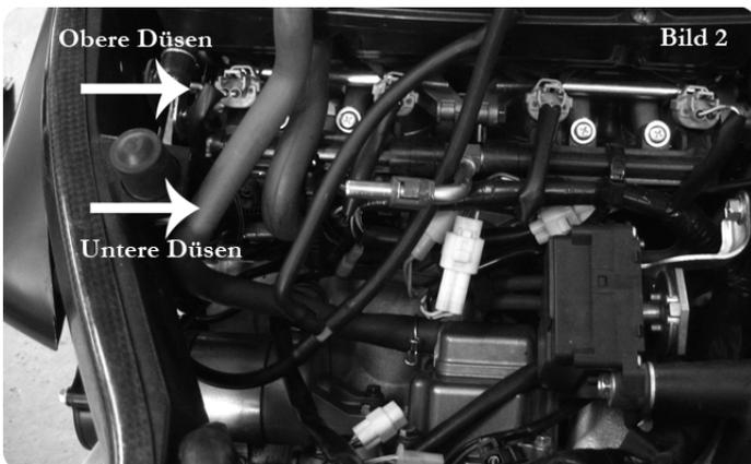
4. Auf dem Bild 2 sind die oberen und die unteren Einspritzdüsen markiert
