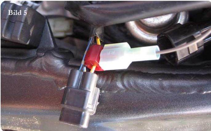
7. Ziehen Sie den Drosselklappenstecker ab und befestigen Sie den mit Pk-Power Dragon mitgelieferten Abzweiger auf das **gelbe** Kabel. Befestigen Sie den Stecker auf dem **grauen** Kabel des Pk-Power Dragon Kabelbaums bis auf Anschlag an den Kabelabzweiger, wie auf dem Bild 5
