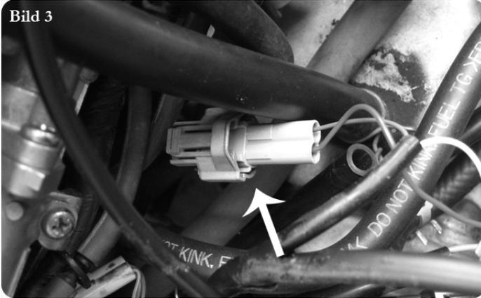
5. Verbinden Sie die Stecker vom Pk-Power Dragon Kabelbaum mit den Einspritzdüsen und mit den Fahrzeugsteckern wie auf dem Bild 4. Achten Sie darauf, dass Sie den Pk-Power Dragon Stecker mit dem **gelben** Kabel mit der **rechten** Einspritzdüse verbinden (Auf dem Bild 2 mit 4 markiert)
