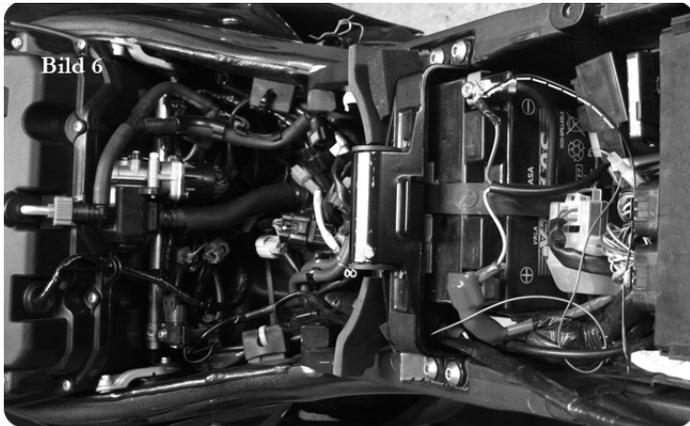
8. Verbinden Sie das schwarze Kabel des Pk-Power Dragon Kabelbaums mit dem Minuspol der Batterie (siehe Bild 6)
